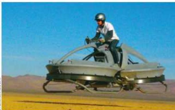
Les fans de *Star Wars* se souviennent de la moto volante que pilotait Luke Skywalker dans *Le retour du Jedi*. Celle-ci est aujourd'hui une réalité grâce à la société américaine Aerofex, qui a testé son prototype dans le désert de Mojave, en Californie. Son double rotor à hélices la propulse à 50 km/h.
